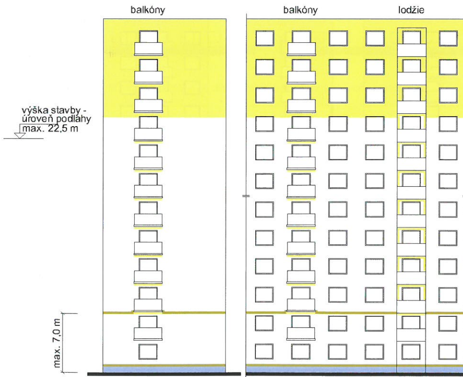
Obr. 14 Rôzne druhy ETICS v oblasti vystupujúcich a ustupujúcich stavebných konštrukcií budov s výškou stavby viac ako 22,5 m s hrúbkou EPS najviac 100 mm
